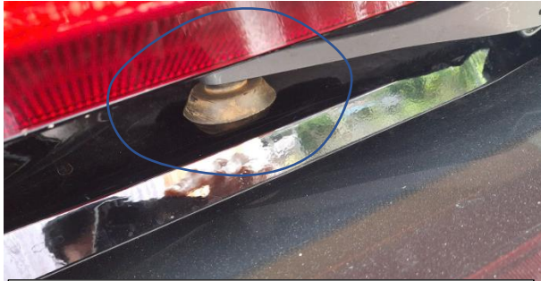
Gạt mưa cửa hậu có dấu hiệu ngập nước
