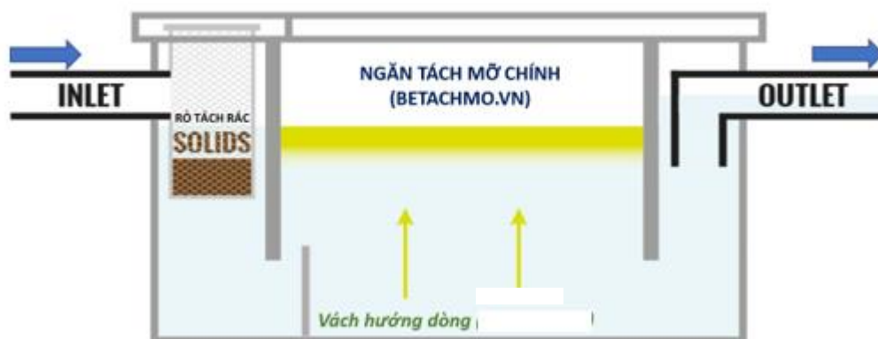
Hình 1. 7. Sơ đồ cấu tạo bể tách dầu mỡ
