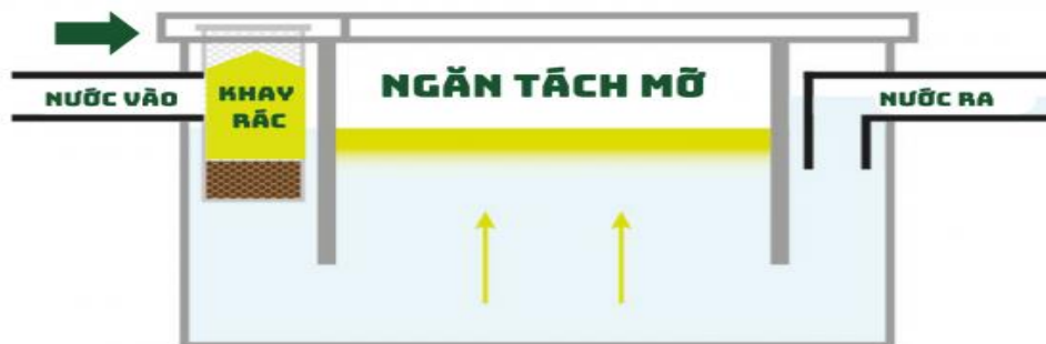
Hình 3.4. Cấu tạo bể tách dầu mỡ
